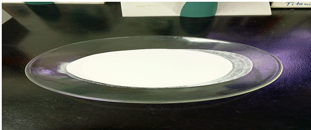
Figura 1. Muestra del material de Referencia Certificado (NIST 699) de alúmina calcinada
