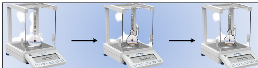
Figura 6. Procedimiento la determinación de la densidad real mediante el método del picnómetro (7)
