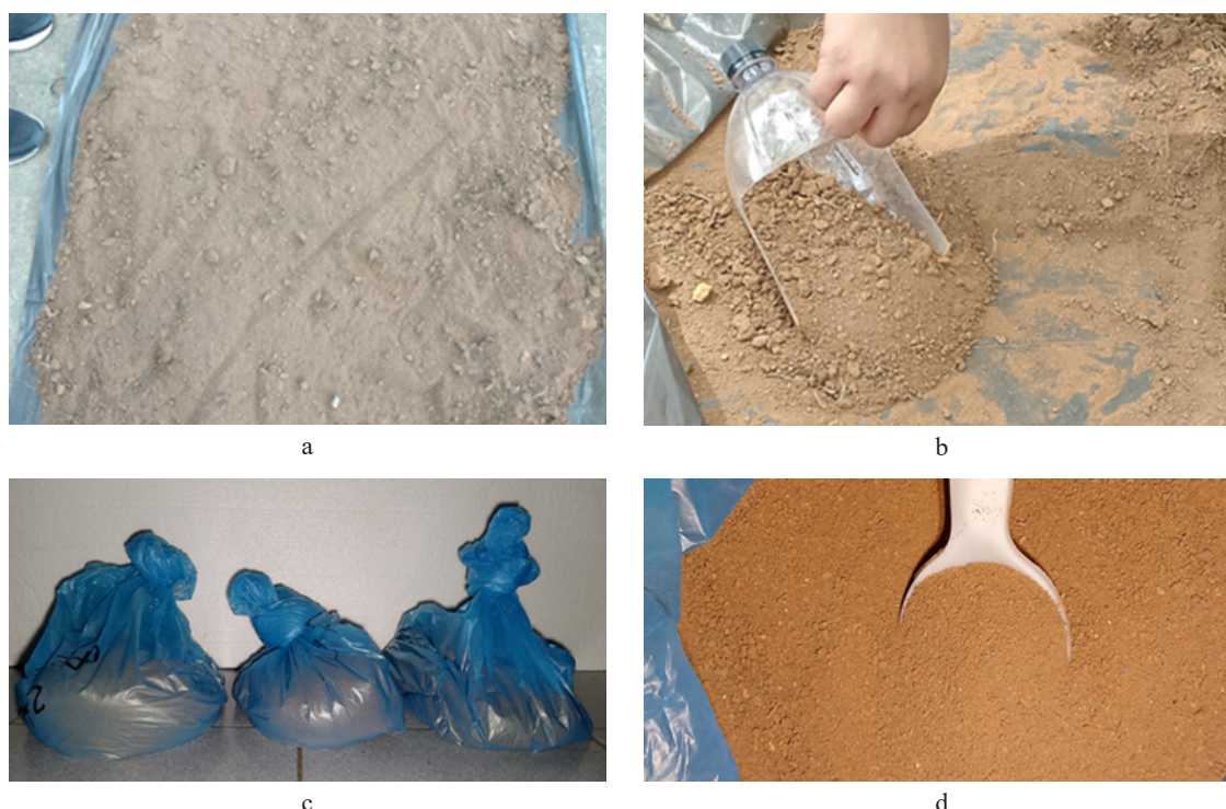
Figura 4. Preparación de la muestra: a) homogenizado y cuarteo, b) descarte de dos fracciones del cuarteo, c) porción de aproximadamente un kilo y d) muestra tamizada
