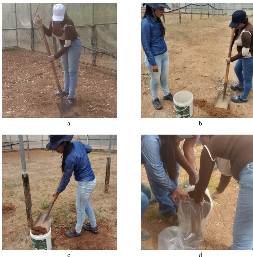
Figura 3. Recolección de la muestra a) remoción de la capa vegetal, b) calicatas, c) muestras colectadas en un balde de plástico, d) traspasó a una bolsa de plástico
