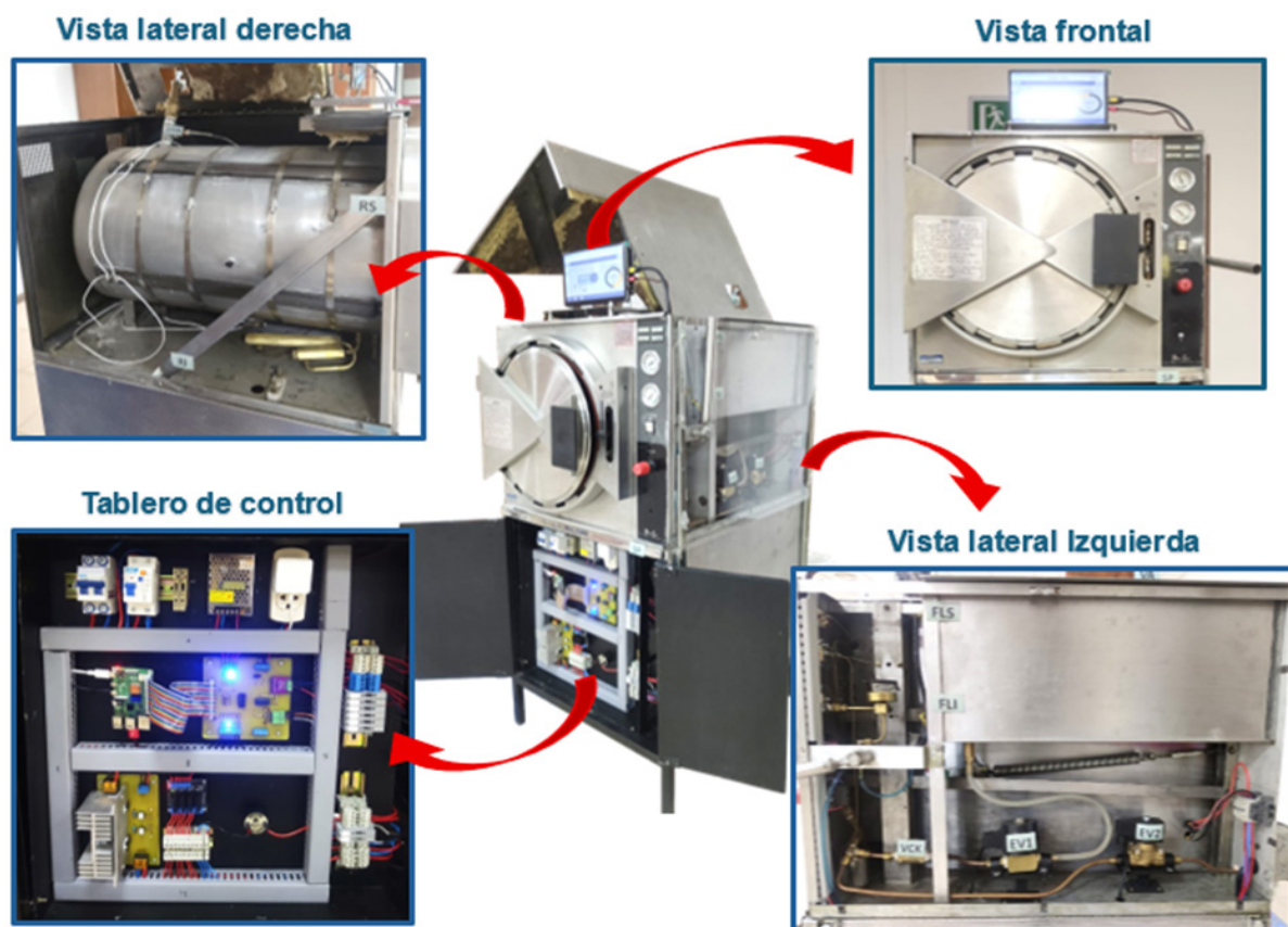
Figura 1. Muestra el equipo didáctico final, resultado del proceso de modernización. Autoclave Pelton et al. modificada como herramienta didáctica, mostrando el interior de la cámara de esterilización y componentes del nuevo sistema de control (sensores, cableado y actuadores)
