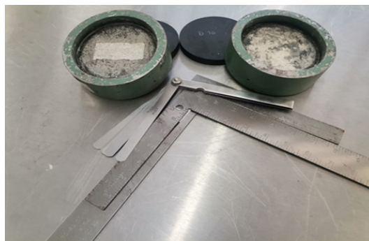
Figura 1. Equipo requerido para el refrendo de cilindros de concreto de acuerdo con la norma ASTM-C-1231
