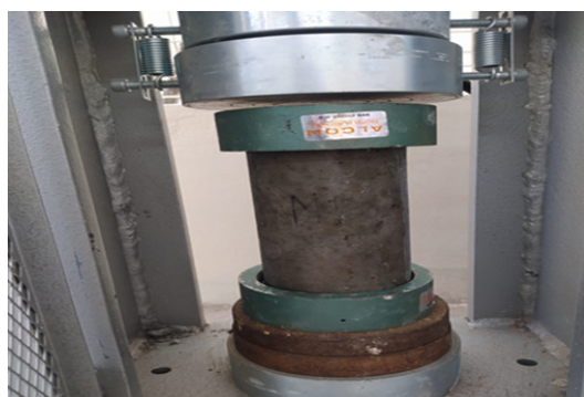
Figura 2. Alineación del eje de la muestra con el centro de empuje de la prensa
