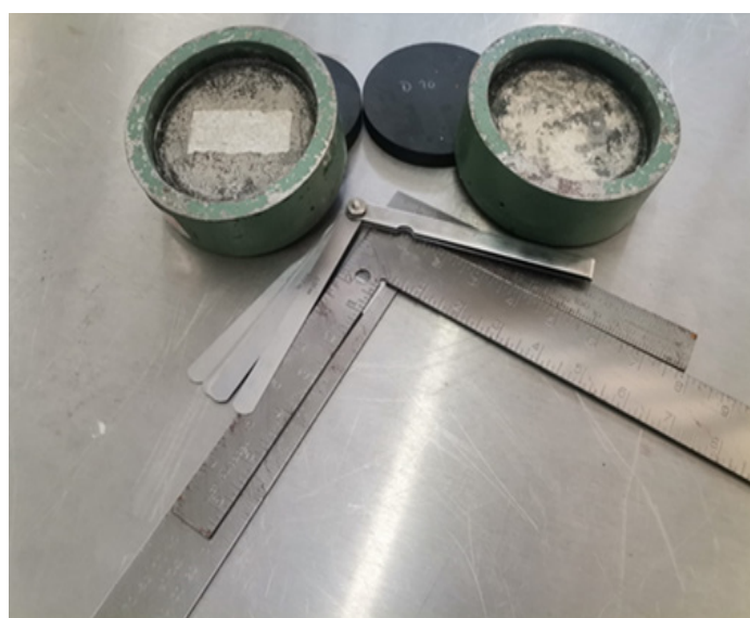
Figura 1. Equipo requerido para el refrendo de cilindros de concreto de acuerdo con la norma ASTM-C-1231
