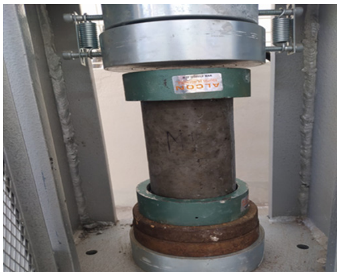
Figura 2. Alineación del eje de la muestra con el centro de empuje de la prensa
